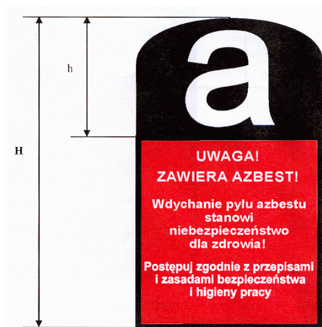
Rys. nr 6. Wzór oznakowania dróg utwardzonych odpadami zawierającymi azbest (H = min. 30 cm).
