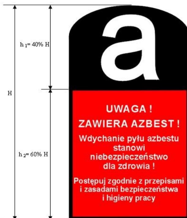
Rys. nr 5. Wzór oznakowania instalacji lub urządzeń zawierających azbest oraz rur azbestowo-cementowych.
